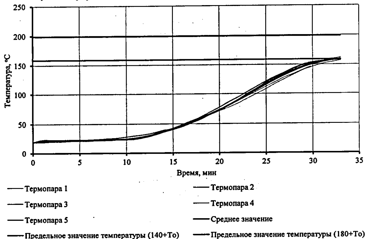
Рисунок 15. График изменения температуры и среднего значения температуры на необогреваемой поверхности полотна образца № НЛ043-287.25-01/2/1
